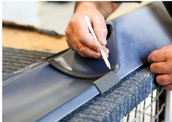
3Dプリント製のマスキング治具により、計測にかかる時間を大幅に削減できる。
