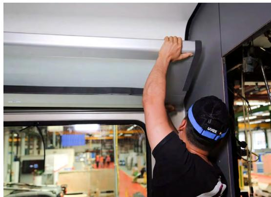
SLS 3Dプリントにより、手荷物棚と壁の隙間にフィットするスリムなデザインを実現。
