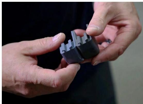
DBは、既存部品をリバースエンジニアリングし、試作品を3Dプリントして検証。実際の寸法とのフィット感を確認した。
