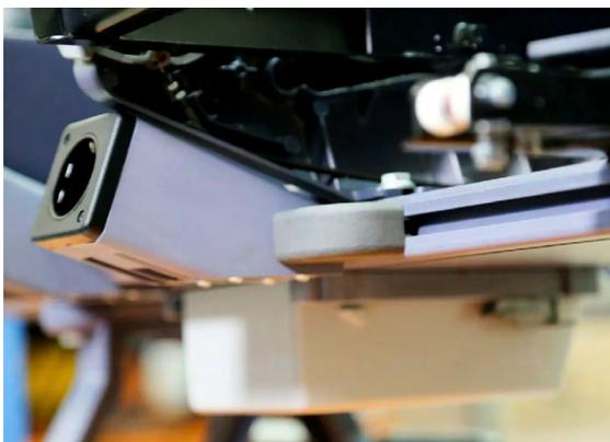
ICE 1車両では、電源ソケットに向けてケーブルを保護・ガイドするカバーキャップの多くが紛失していた。
