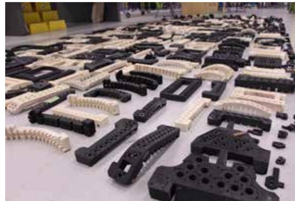
XB-1 実証機の製造に使用された 3D プリンタ造形によるドリルガイドのサンプル
