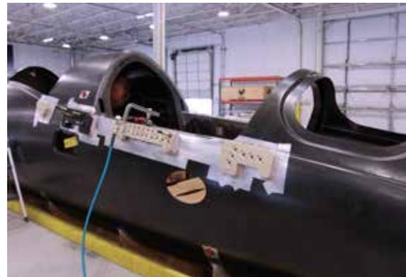
XB-1 胴体の炭素繊維強化プラスチック (CFRP) とチタンの積層体にファスナーの穴を開けるために使用される 3D プリントされたドリルガイド
